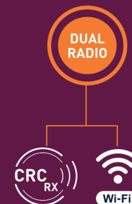
La serie WRX è dotata di un doppio modulo radio Wi-Fi e Cherubini CRC RX. Tramite il protocollo Wi-Fi, i motori possono essere direttamente inclusi nella rete Wi-Fi utilizzando la app META by Cherubini e scansionando il QR Code del singolo motore.
